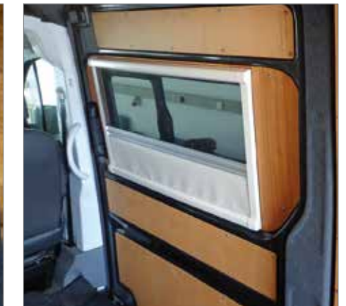
Nachträglich angebrachte Verdunkelung mit Mückenschutz an bereits vorhandenem Fenster
