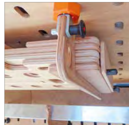
Abnehmbare Anschläge auf beiden Seiten verhindern das Verrutschen der Ladung
