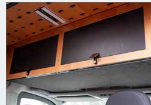
Ablage-Modul als Stauschrank mit Klappen nach oben
