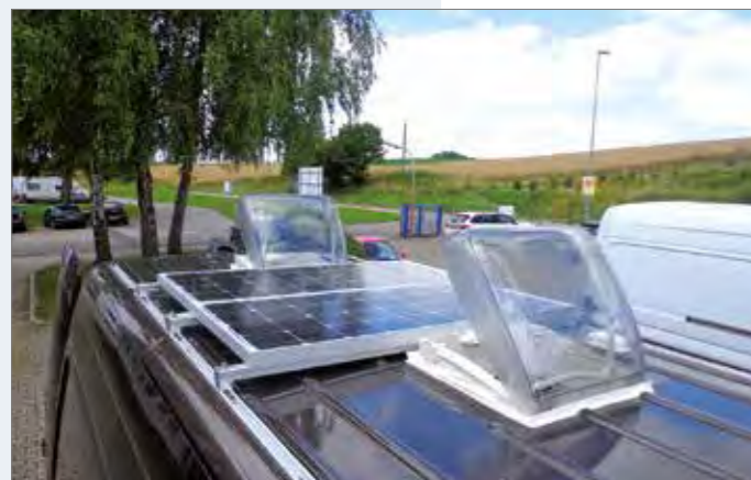
Die Solaranlage kann perfekt zwischen zwei Dachfenster montiert werden
