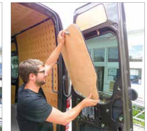
Die Vollverdunkelung lässt sich einfach mit wenigen Handgriffen einsetzen und wieder entfernen
