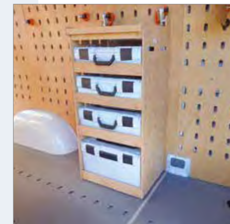
Das Werkstattregal: für jeden Werkzeugkoffer oder Schäferkisten in Kombination anpassbar. Befestigungs-Clips können in den Seitenwänden z.B. für Schlauch und Kabelhalterung... angebracht werden
