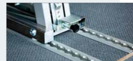
Bodenschienen mit flexibel platzierbarem Einzelsitz
