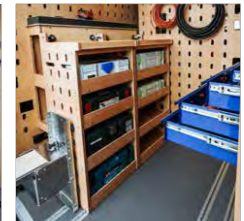
Das Werkstattregal: für jeden Werkzeugkoffer oder Schäferkisten in Kombination anpassbar. Befestigungs-Clips können in den Seitenwänden z.B. für Schlauch und Kabelhalterung... angebracht werden
