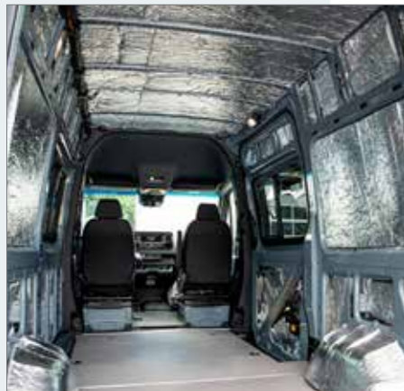
Durchgängige Isolierung des Fahrzeugs
