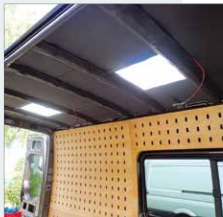
Deckenisolierung mit 2 Dachfenstern
