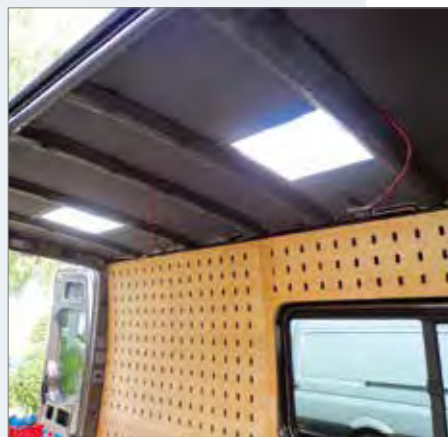
Deckenisolierung mit 2 Dachfenstern
